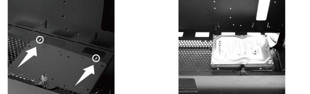
硬盘架对位，把安装好的硬盘架装到电源仓上面硬盘位固定螺丝
