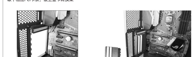
用铜柱套将显卡专用铜柱固定在电源仓对应孔位，将显卡延长线插入主板，另一端放在铜柱上
