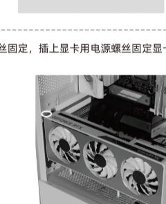
将显卡延长线插入主板，另一端放在铜柱上，用主板螺丝固定，插上显卡用电源螺丝固定显卡
